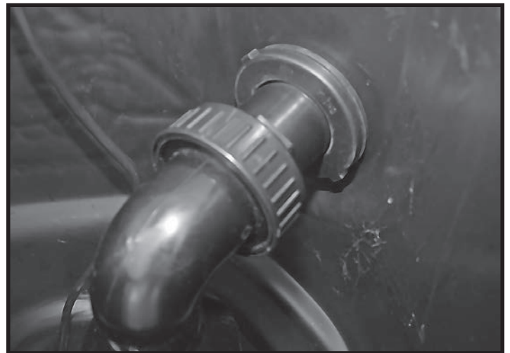
Ex. 15 Un adaptateur se visse directement dans la pompe et l'autre dans la cloison arrière de l'écumoire. Recouvrez le filetage du raccord de silicone ou de ruban de téflon (non fourni).
